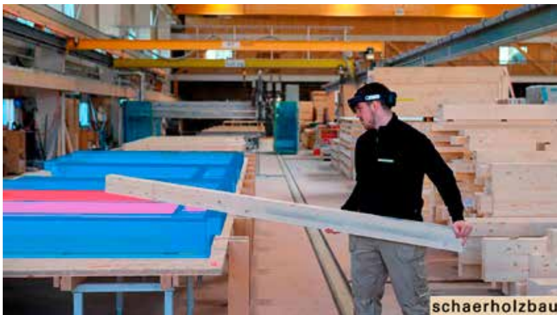
(17) Realidad Mixta aplicada a la producción de módulos prefabricados. Los operarios en planta ya no tienen por qué consultar planos impresos durante el montaje, sino que a partir del modelo 3D, estos planos y toda la información del modelo también pueden visualizarse espacialmente en Realidad Mixta. La app ElementBau para HoloLens 2 permite un flujo de trabajo digital desde la planificación BIM/CAD hasta el montaje en obra. En la foto un operario de la empresa Schaerholzbau ag poniendo en práctica esta tecnología.
